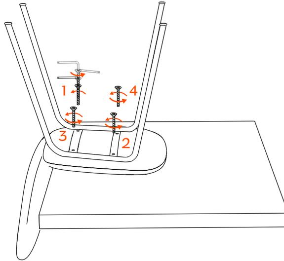
Posizionare la struttura della sedia capovolta sopra la seduta ed avvitare i due componenti con le viti fornite. | Put the chair metal base on the shell layed previously upside-down and screw the two elements with the supplied screws.
