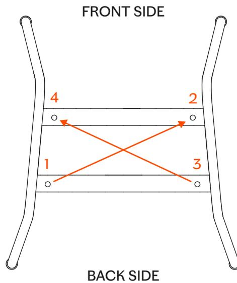
Avvitare la base seguendo l'ordine dei numeri illustrati, per garantire maggior precisione nel montaggio. | Screw the metal base, following the illustrated order, to ensure a higher precision.
